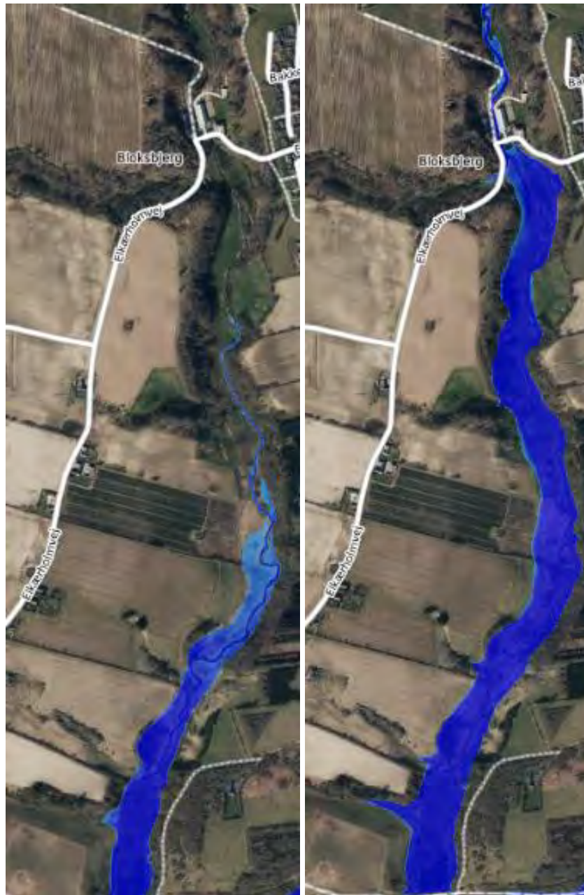
Figur 43 Udbredelsen af stuvning i Vester Nebel Å for hhv. kote 27(tv) og kote 30(th).
