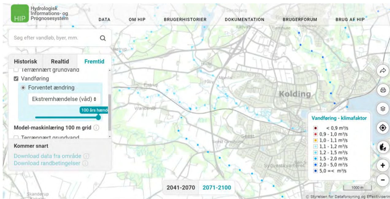
Figur 11 Eksempel på resultater fra HIP, med angivelse af klimafaktorer pr. 500 m ned gennem Kolding Å systemet. Her for en fremtidig 100-årshændelse i et højt klimascenarie (RCP8,5)
