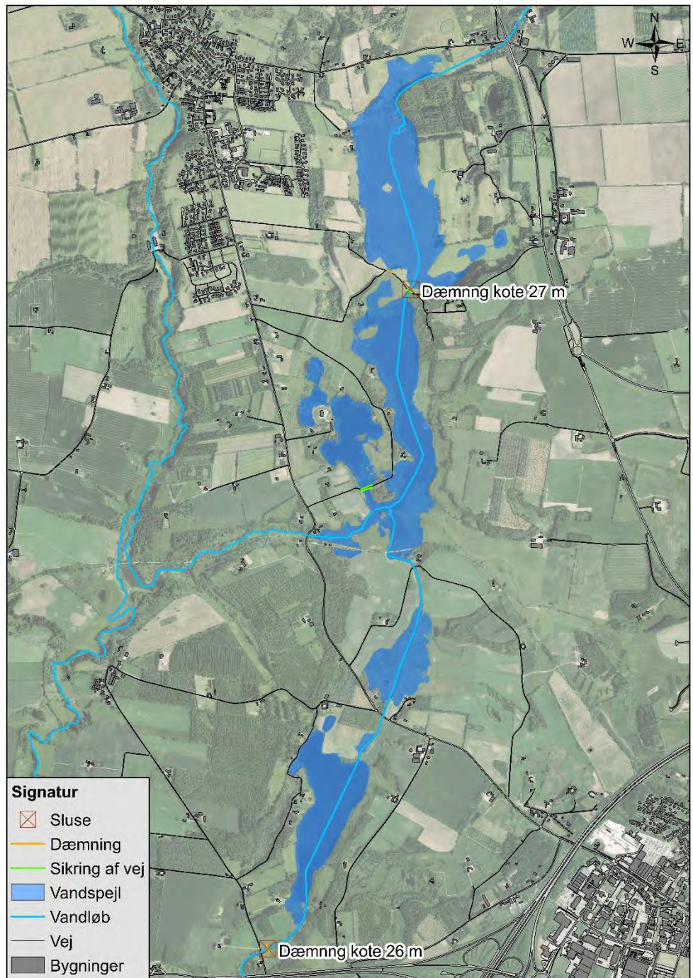
Figur 32 Oversigt over tiltag ved scenarie 1 i Dons Søerne, hvor der opstaves til kote 26/27.
